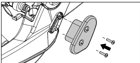
1. Die untere Kabelaufwicklung für das Elektrokabel an der dafür vorgesehenen Stelle, mit den mitgelieferten Schrauben am Rahmen verschrauben.
