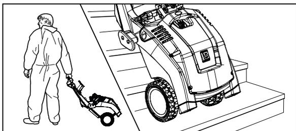
2. Den Hochdruckreiniger zum Einsatzort bewegen. Der Kränzle 1050 TS ist eine fahrbare Maschine mit robustem geländegängigen und treppentauglichen Fahrwerk.
