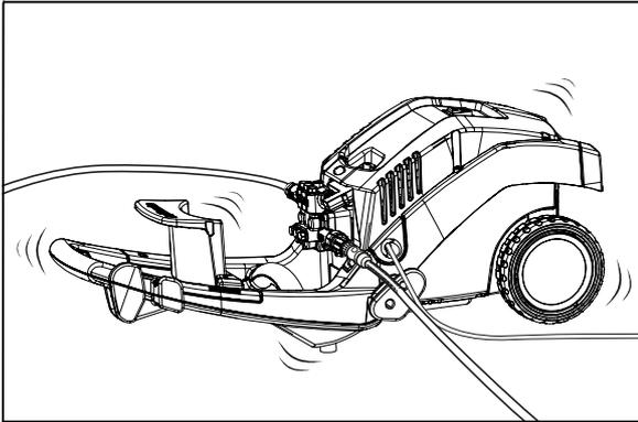
Nach dem Schließen der Sicherheitsabschaltpistole muss sich die Maschine abschalten. Wenn die Abschaltung nicht erfolgt, kann Leckage an der Pumpe, am Druckschalter, am Hochdruckschlauch, oder an der Sicherheitsabschaltpistole die Ursache sein.
