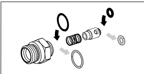
Sind die Dichtungsringe defekt, sofort O-Ringe austauschen.
