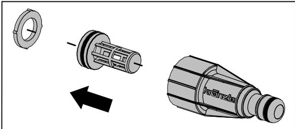
**9.1** Bei Verschmutzung, das Sieb herausnehmen und mit den den restlichen Teilen unter klarem Wasser gründlich ausspülen und reinigen.
