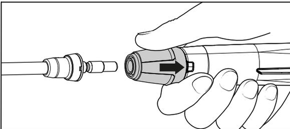
7. Die Sicherungshülse der Pistole erst zurückziehen, dann die Lanze in die Steckkupplung der Pistole stecken.
