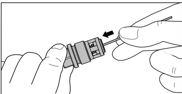
Säubern Sie die Ventile mit einem Draht (Büroklammer) und möglichst unter fließendem Wasser.
