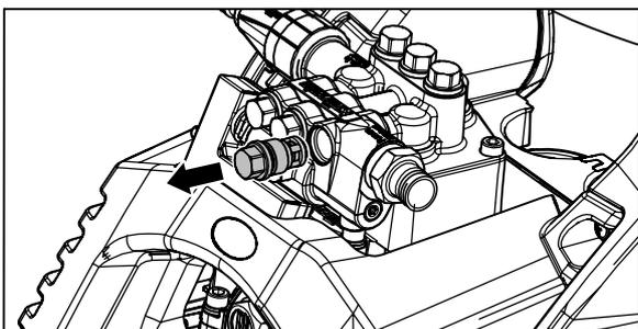
Entnehmen Sie die Schraube mit Ventilkörper samt O-Ring. Kontrollieren Sie den Dichtungsring auf Beschädigung. Bei Beschädigung muss der O-Ring ausgetauscht werden.
