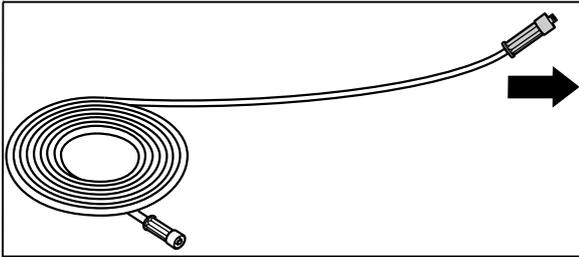
4. Hochdruckschlauch gerade und schlingenfrei ausrollen. (Bei Verlängerung des Hochdruckschlauches die maximale Länge von 20 m beachten!)
