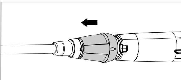
8. Nach Einstecken der Lanze die Sicherungshülse loslassen und auf einen sicheren Sitz der Lanze achten.
