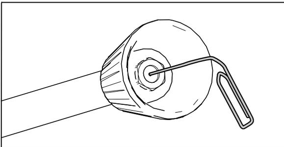
Besteht das Problem weiter, so durchstoßen Sie mit einem Draht (Büroklammer) vorsichtig die Düsenöffnung. Sollte das Reinigen mit einem Draht nicht den gewünschten Erfolg bringen, so muss die Lanze ersetzt werden.
