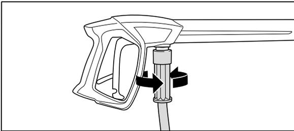
6. Hochdruckschlauch an der Sicherheitsabschaltpistole fest und druckdicht verschrauben.
