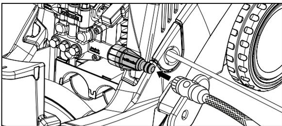
**10.** Wasserschlauch an den Wassereingang anschließen. Der Hochdruckreiniger kann wahlweise an eine Druckwasserleitung (1 - 10 bar Vordruck) mit kaltem oder bis zu 60 °C warmem Wasser angeschlossen werden.
